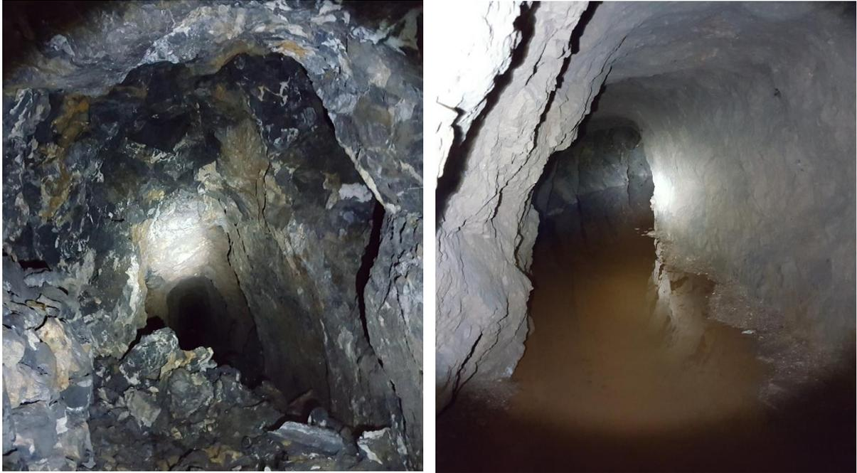
Figura 41. Zona inestable estéril general y galería inundada en 2º piso ramal derecho. (Fuente: propia, 2018)
