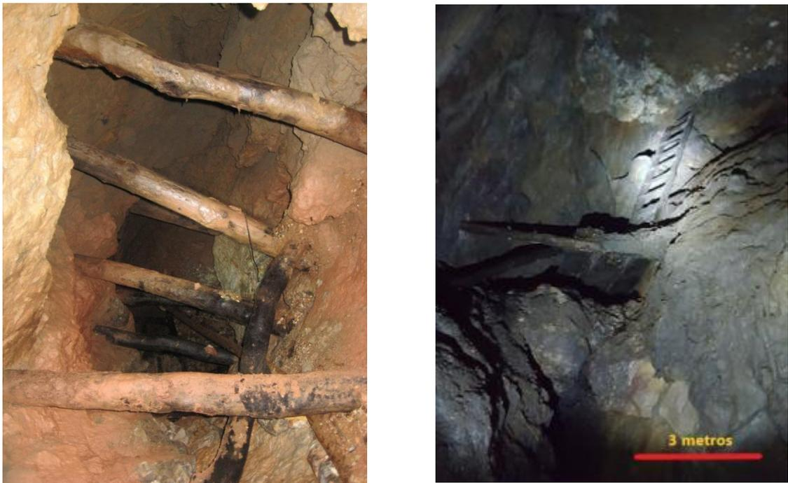
**Figura 24. Uso de madera para entibación (izda) y desplazamiento en labores verticales (dcha). (Fuente: propia, 2016)**
